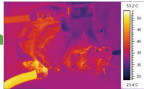
Begrenzter Temperaturanstieg von nur 25 °C im Kompressorelement
